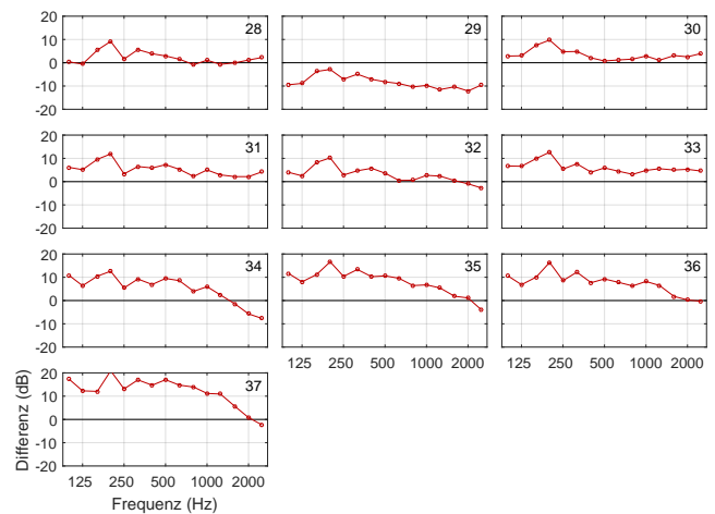
Abbildung 8: Vergleich der Energien aus dem SEA Modell mit Messdaten nach Gleichung (7) für die Spanplatten auf der abgewandten Wandseite.
