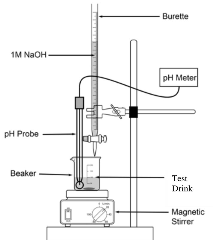
Figure 2.19: Titratable acidity apparatus
